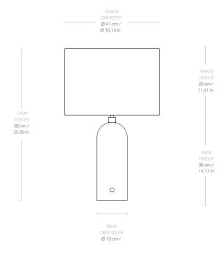
LAMP WIDTH 41 cm 41 cm LAMP DEPTH LAMP HEIGHT 65 cm Ø 41 cm SHADE DIAMETER SHADE HEIGHT 29 cm Ø 13 cm BASE DIAMETER BASE HEIGHT 36 cm CORD LENGTH 200 cm
